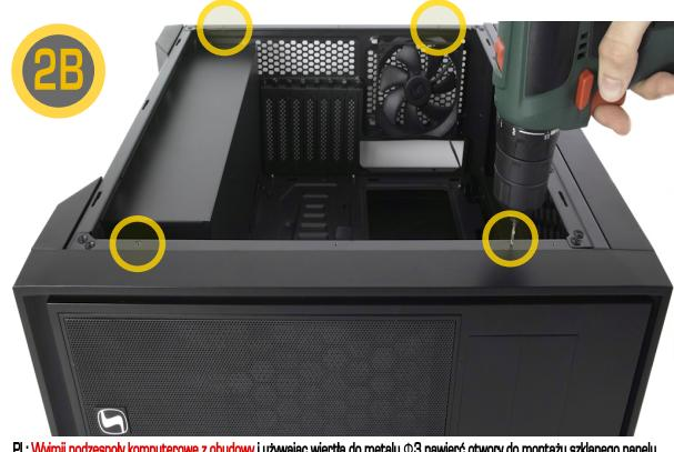
PL: Wyjmij podzespoły komputerowe z obudowy i używając wiertła do metalu Ø3 nawiń otwory do montażu szkłanego panelu.
