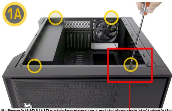
PL: Używając śrubki M2.5 lub M3 rozwierć otwory przeznaczone do montażu szkłanego panelu (wkroić i wykręcić śrubkę).
